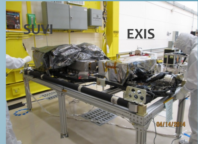
SUVI y EXIS instalados en la Plataforma Orientada hacia el Sol
